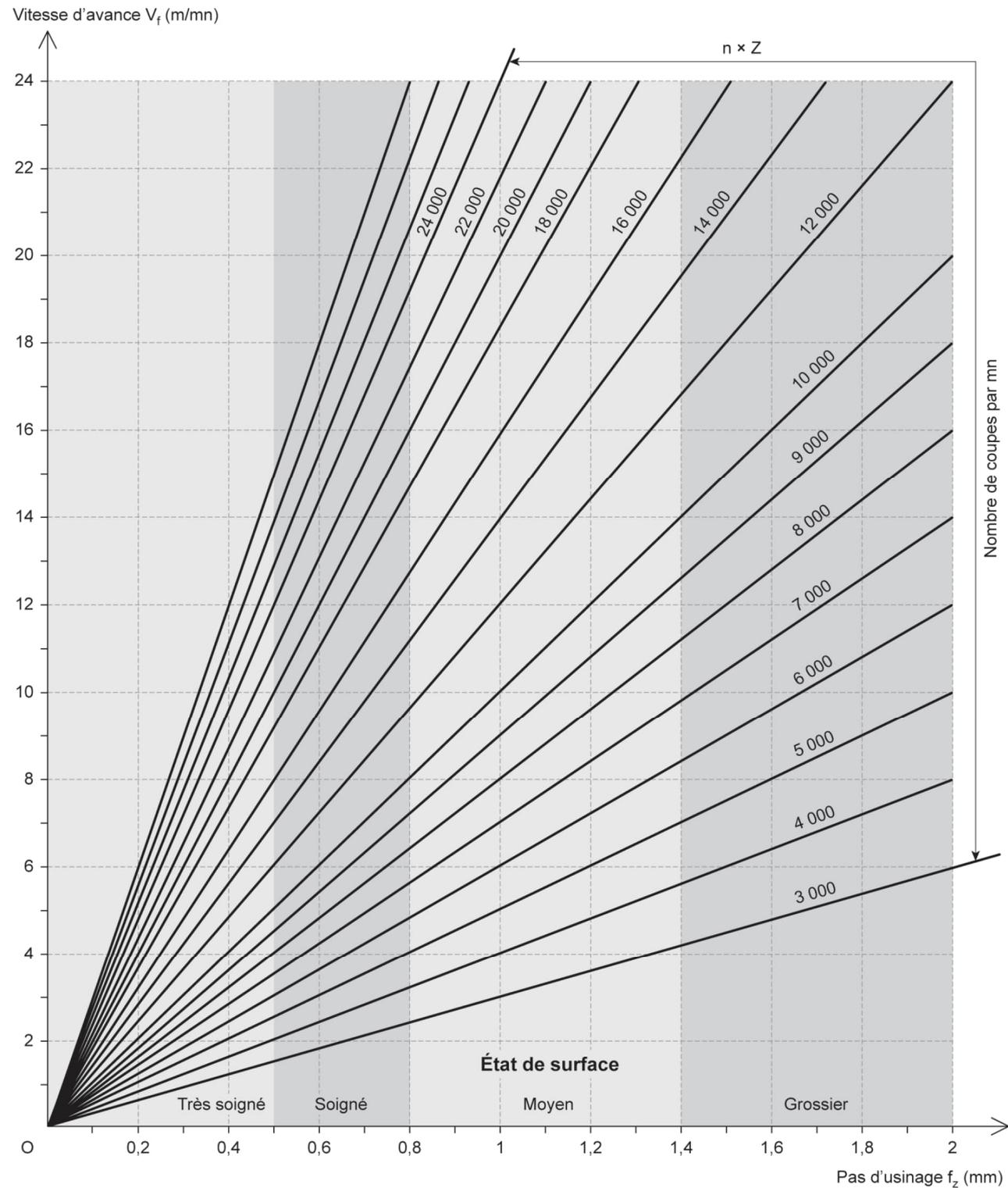
C'est par des réglages sur les machines-outils que l'on peut modifier ces paramètres, afin d'obtenir l'état de surface recherché.
