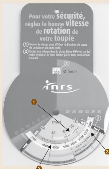
Nous souhaitons usiner un bois tendre avec un outil de **220 mm** de diamètre en acier rapide (**HS**).
