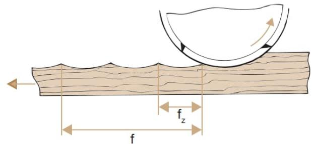
Le pas secondaire conditionne la finesse du travail exécuté et donc l'état de surface. Il permet de régler la vitesse d'avance de la pièce.
