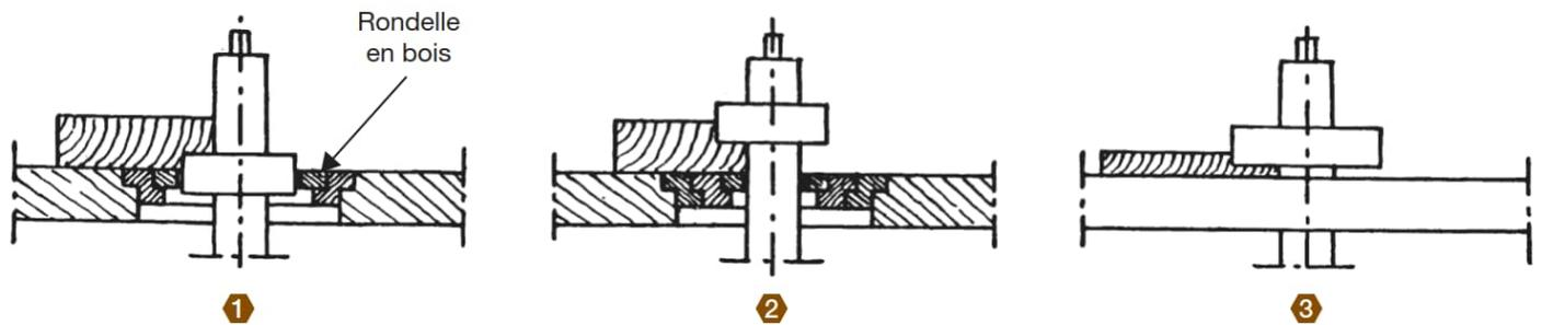
**Le travail par-dessous** ① est recommandé car il est moins dangereux puisque l'outil est caché par le bois. De plus, il ne permet pas de prendre plus de matière que prévu, même dans le cas de pièces gauches ou cintrées.
