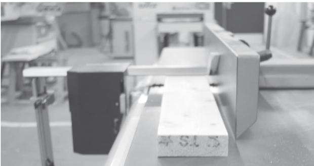
Le guide pourra être réglé en fonction de l'angle à réaliser sur un chant. Le guide est réglable entre 0 et 45° :
