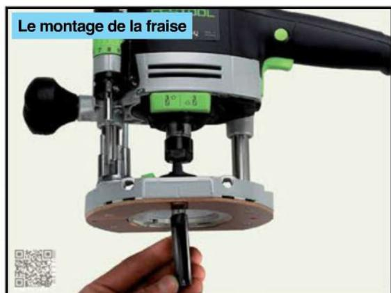
Débranchez la machine. Bloquez l'arbre en appuyant sur le bouton. Dévissez légèrement l'écrou, introduisez la fraise dans la pince, puis serrez fermement.
