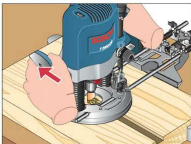
3 Réalisez le fraisage en poussant la machine, tout en plaquant la semelle sur la pièce. Avancez régulièrement, doucement et sans à-coups.
