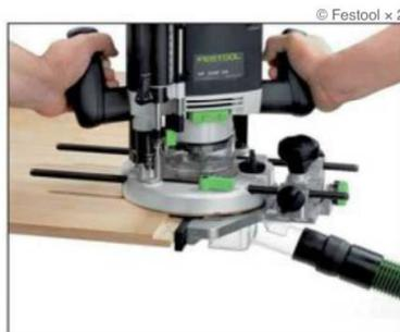
Dispositif d'aspiration fixé sous la semelle de la machine
