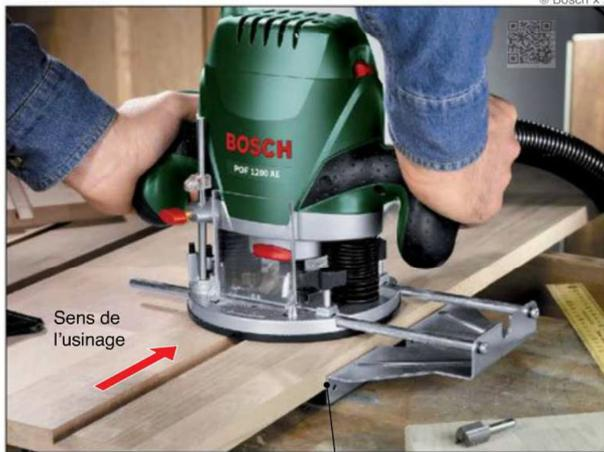
Joue de guidage en appui contre la pièce pendant l'usinage
