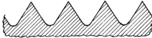
Ce type de denture est plus utilisé lors du tronçonnage
