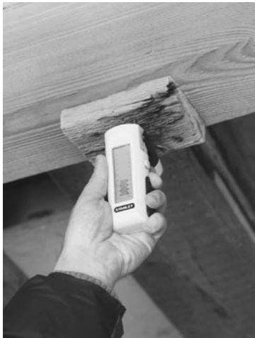
Figure 6.1 Humidimètre à résistance électrique
