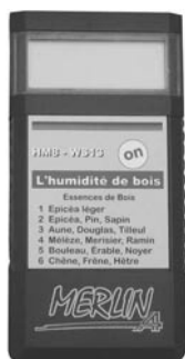
Figure 6.3 Humidimètre à mesure capacitive
