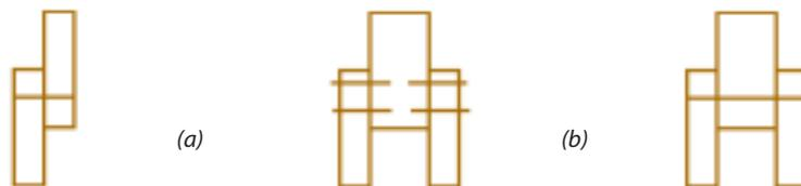
Figure 22. Assemblage par tige sollicité en simple (a) ou en double cisaillement (b).
