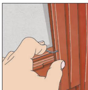
L'emboîtement de la tuile est « crocheté » par l'extrémité du crochet de pannetonnage
