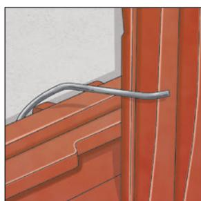
Vue du crochet de pannetonnage en place avec la tuile
