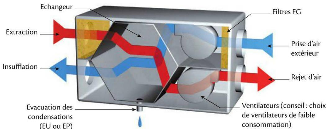
Figure 9 : Schéma de principe d'une centrale double flux
