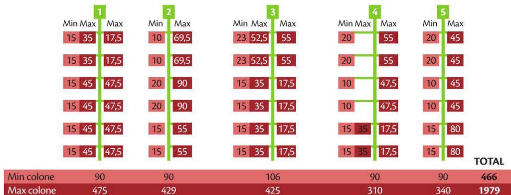
Figure 3 : Représentation des débits foisonnés par colonne
