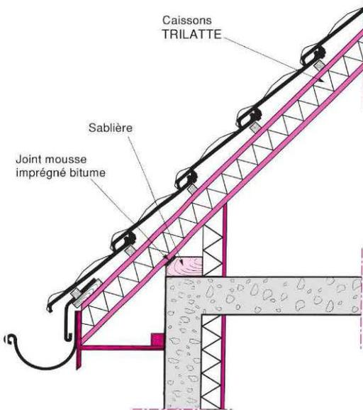
Fig. 35 : Détail de l'égout avec débord et habillage horizontal
