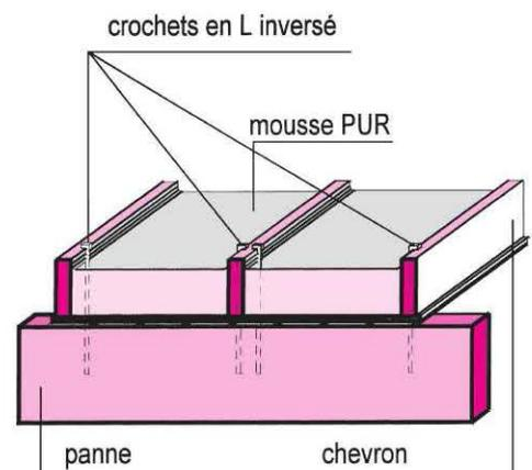
Fig. 33 : Détail de fixation sur panne
