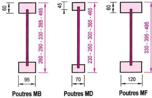
Fig. 61 : Coupes transversales « mégapoutre »
