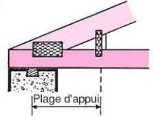
Fig. 72 : Plage d'appui variable
