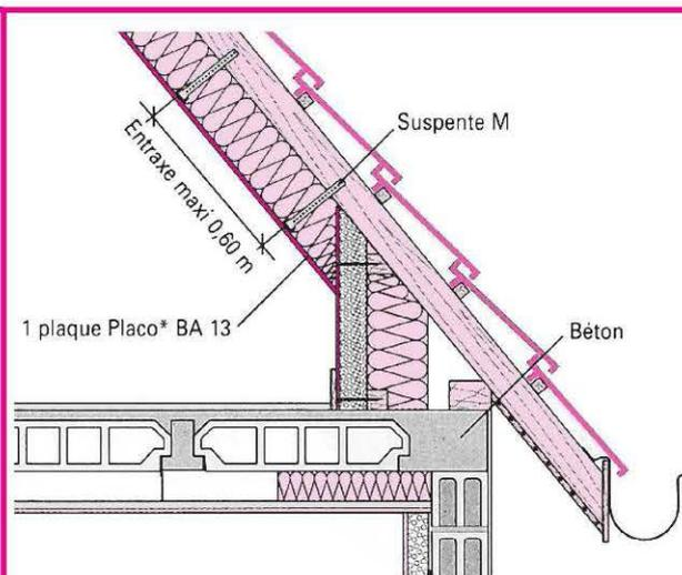
8 Isolation en combles à l'aide de suspentes fixées directement sur les chevrons et isolant en sous-face de plancher béton
