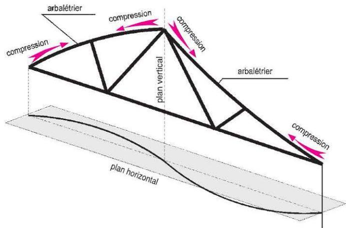
Figure 6 : risque de déformation des arbalétriers comprimés → flambement
