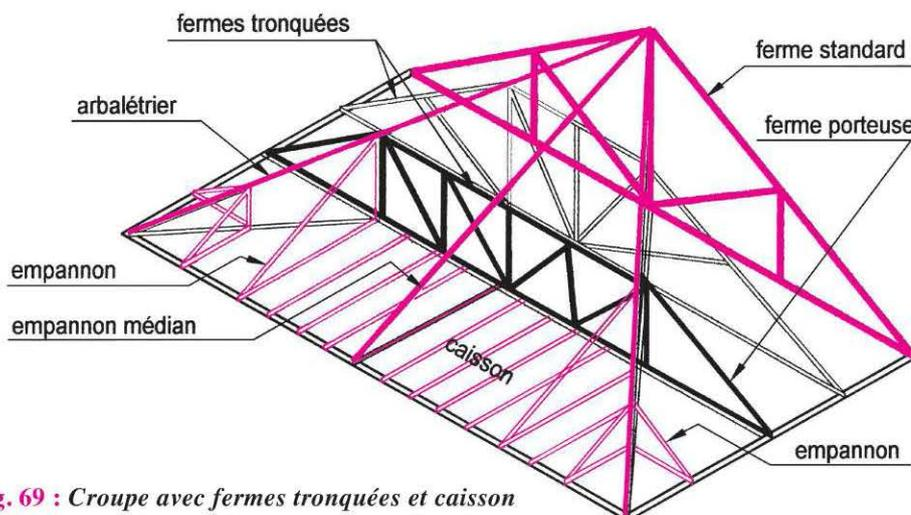
Fig. 69 : Croupe avec fermes tronquées et caisson
