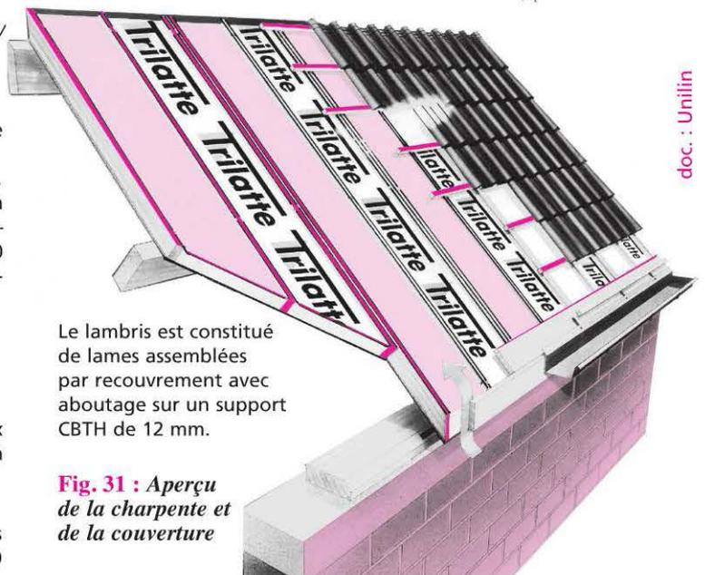
Le lambris est constitué de lames assemblées par recouvrement avec aboutage sur un support CBTH de 12 mm.
