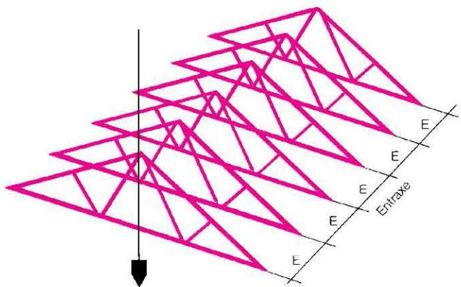
**Figure 32 :** règles impératives : verticalité et espacement
