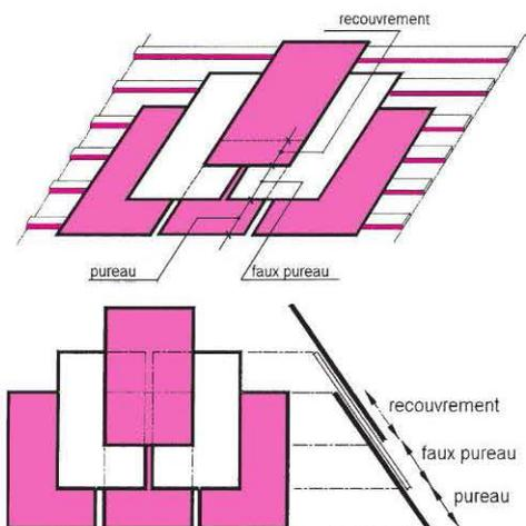
Fig. 44 et 45 : Notion de pureau et de recouvrement
