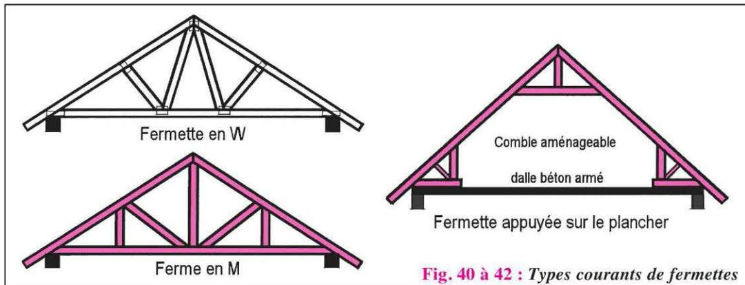
Fig. 40 à 42 : Types courants de fermettes
