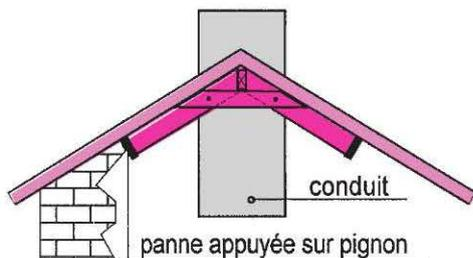
**Figure 25 : deux contrefiches en butée sur les pannes**
