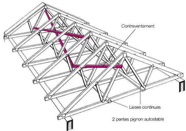
**Figure 31 :** contreventement par triangulation
