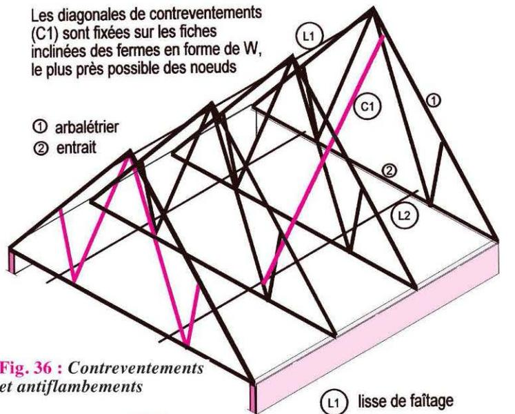
Fig. 36 : Contreventements et anti-flambements
