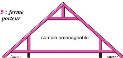
Les saillies de toiture et d'auvent permettent de personnaliser la toiture en bas de versant.
