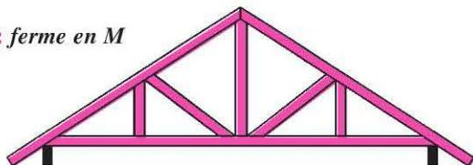
Figure 13 : ferme à appuis sur plancher
