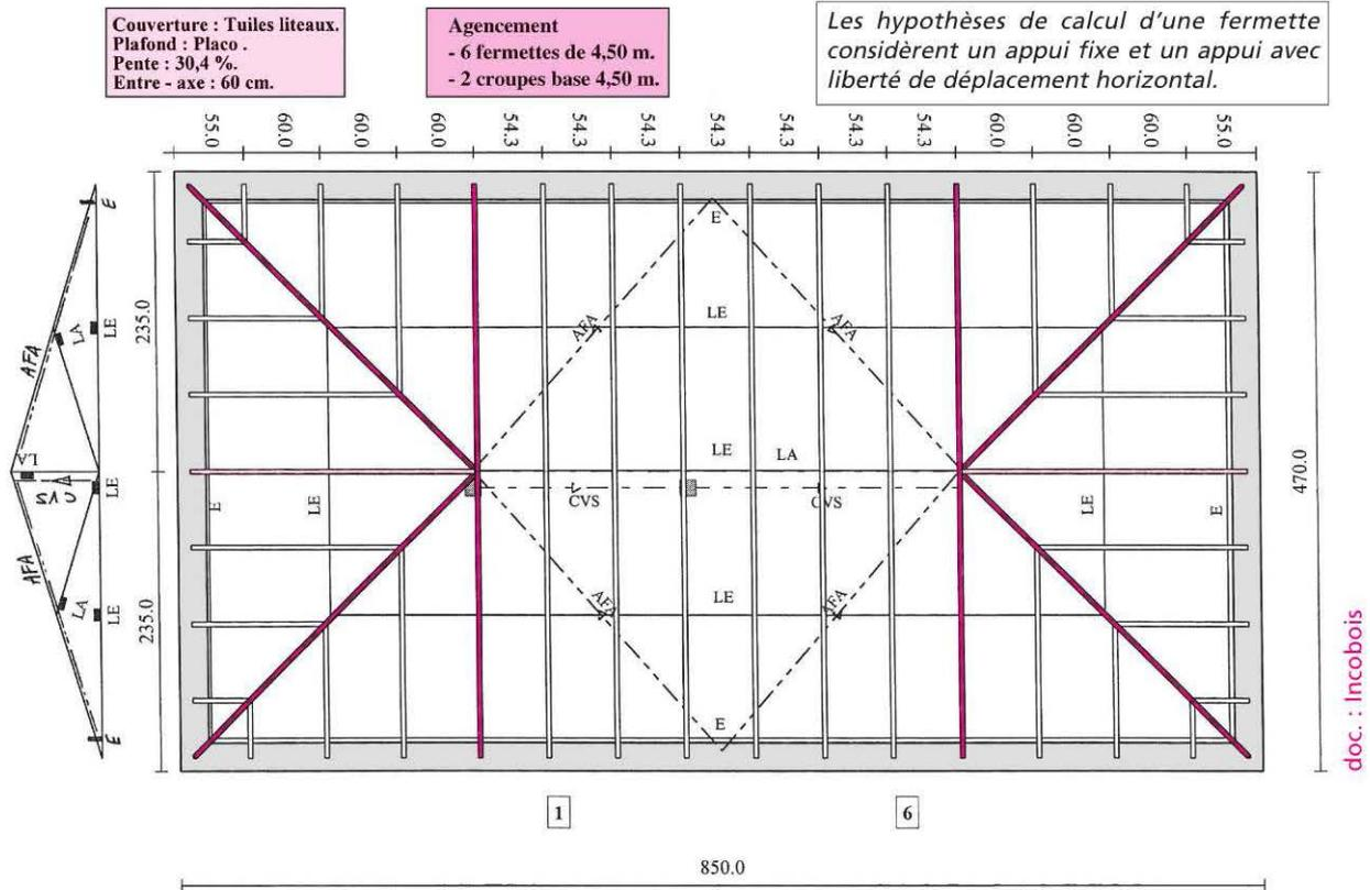
Fig. 79 : Plan de répartition avec dispositifs de stabilité
