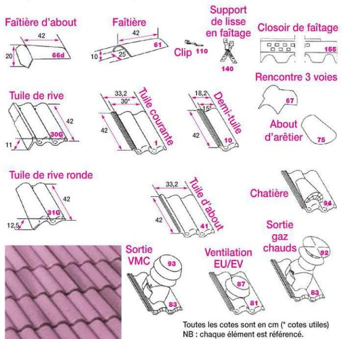
Figure 34 : tuiles et accessoires
