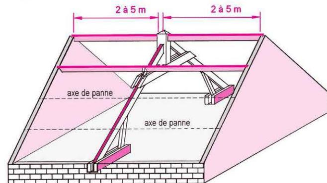
Fig. 76 : Combles habitables et ferme à entrait retroussé
