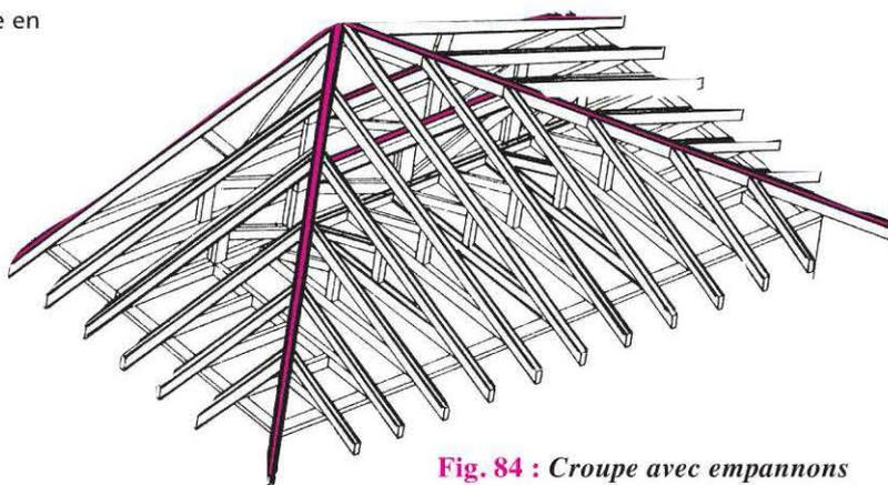
Fig. 84 : Croupe avec empannons triangulés pour toiture à pente faible
