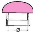
Le diamètre intérieur de l'embase correspond au diamètre extérieur des tubes PVC.
