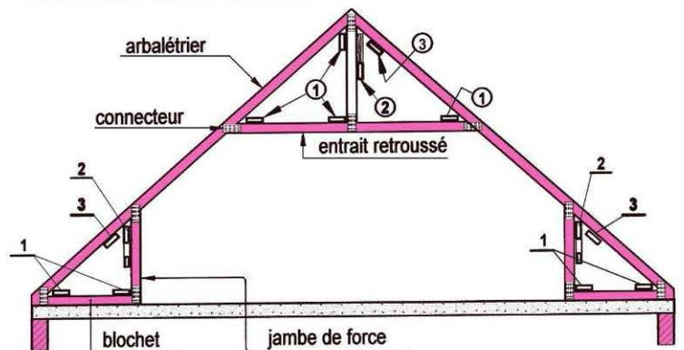
Fig. 39 : Positions des éléments de stabilité
