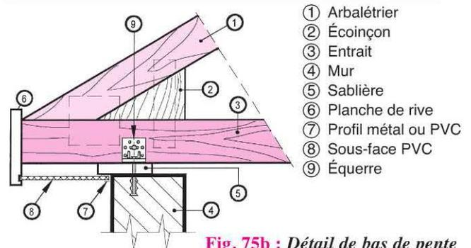
Fig. 75b : Détail de bas de pente
