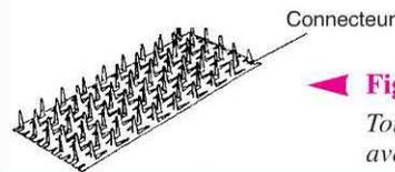
Figure 3 : connecteur métallique à dents
