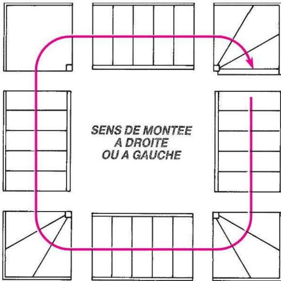
Figure 4 : palier de repos ou quartier tournant de  $0,80 \times 0,80$  à 3 marches
