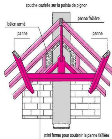
**Figure 23 : ceinturage du conduit dans l'épaisseur du chevronnage**
