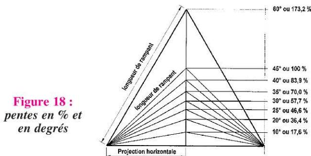
Figure 18 : pentes en % et en degrés
