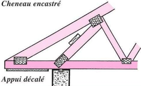
Fig. 75 : Appui décalé
