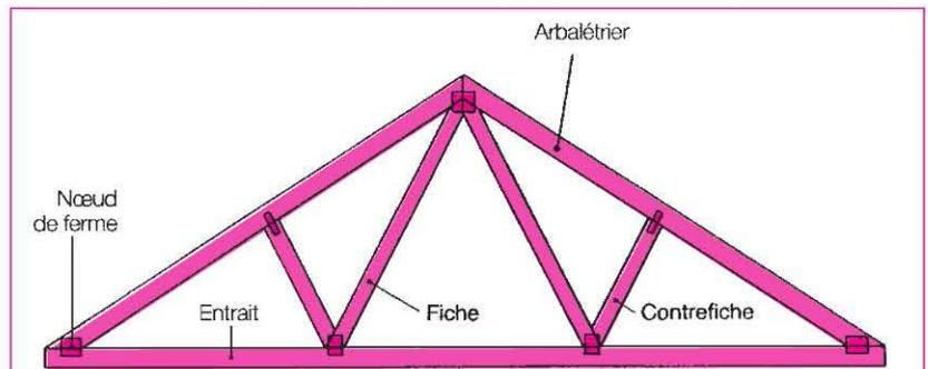
Figure 2 : terminologie des éléments d'une fermette
