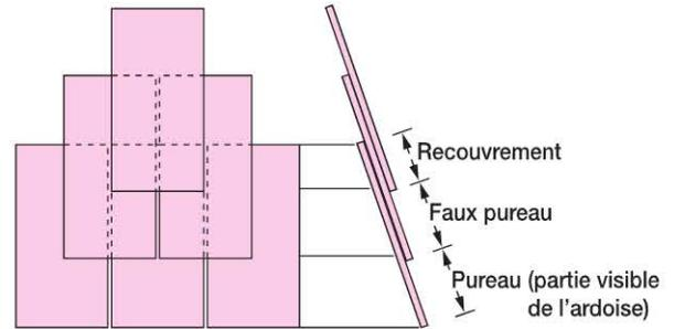
Figure 17 : recouvrement des ardoises
