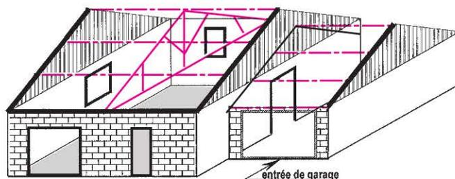
**Figure 11 : ferme intermédiaire dans une zone habitable et pannes appuyées sur les pignons pour le garage (solution fréquente)**
