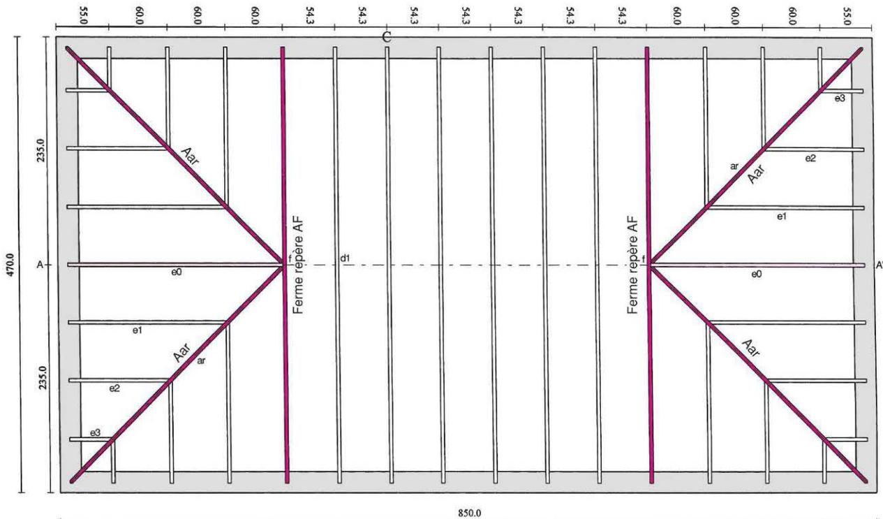
Fig. 78 : Plan de la répartition globale des fermes et des empannons
