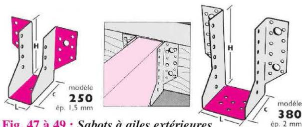
Fig. 47 à 49 : Sabots à ailes extérieures
