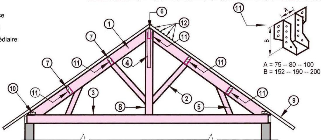
**Fig. 46 :** Ferme de charpente classique avec pannes positionnées par des sabots fixés sur les arbalétriers
