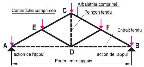
Figure 22 : action des charges verticales concentrées aux nœuds
