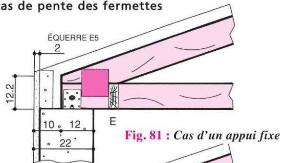
Fig. 81 : Cas d'un appui fixe
