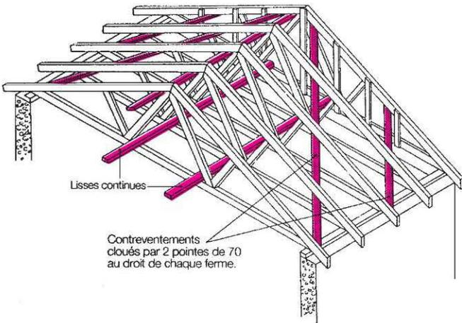
**Figure 27 :** dispositif anti-flambement
