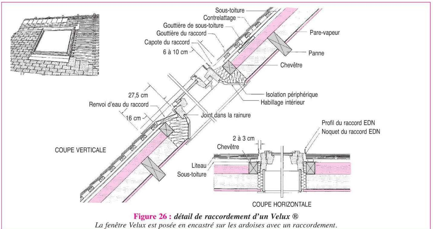
**Figure 26 :** détail de raccordement d'un Velux®
