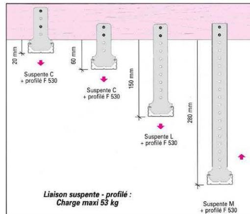
2 Suspentes type F avec deux points de fixation par sus-
