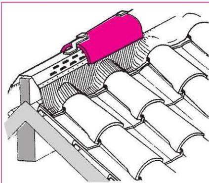
Crochet de fixation pour tuiles de faîtage et d'arêtier
