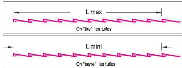
Figure 20 : pureau moyen :  $(L_{max} + L_{min})/20$
