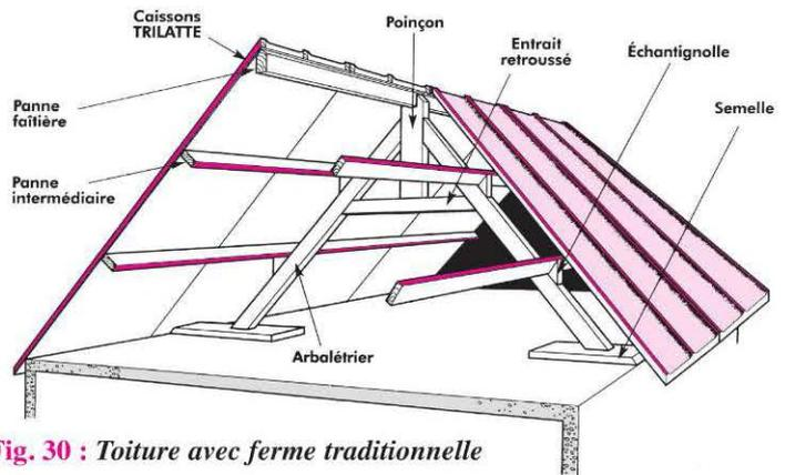
Fig. 30 : Toiture avec ferme traditionnelle
