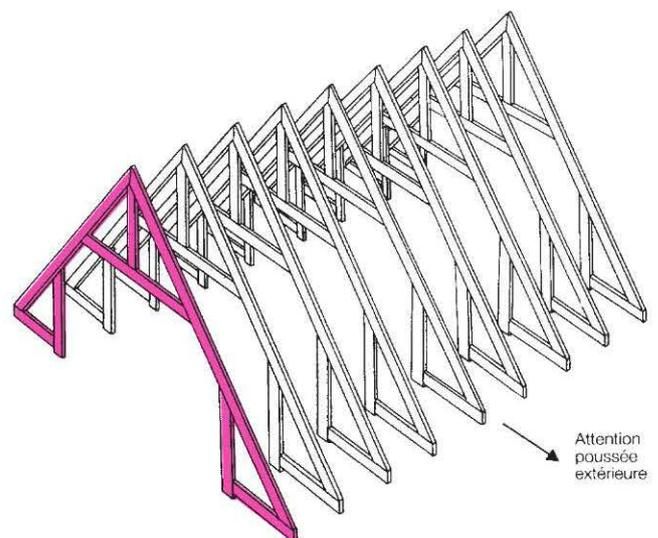
Figure 5 : fermettes à entrain retroussé pour combles habitables
