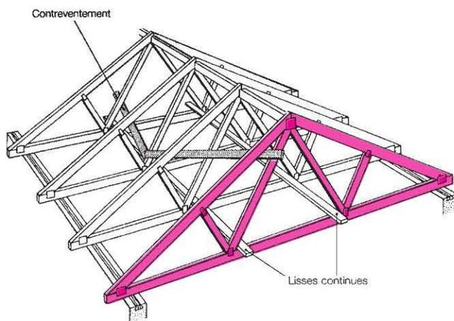
Figure 4 : vue d'ensemble avec combles perdus
