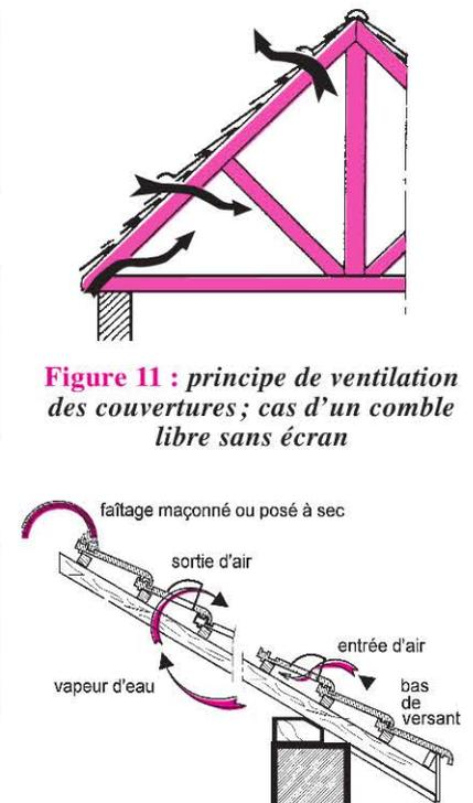
Figure 11 : principe de ventilation des couvertures ; cas d'un comble libre sans écran
