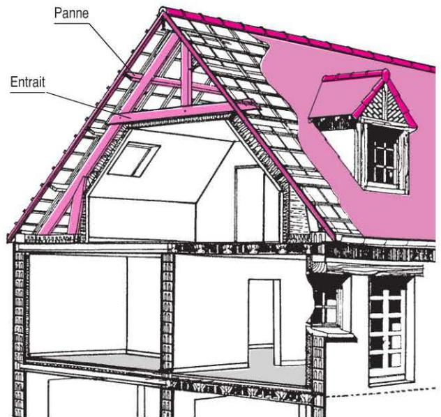
Figure 1 : charpente traditionnelle avec entrait retroussé en comble habitable
