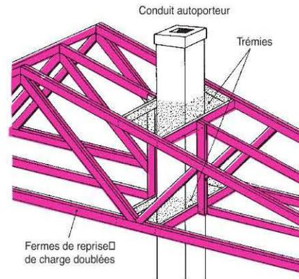
Figure 33 : passage d'un conduit et chevêtres
