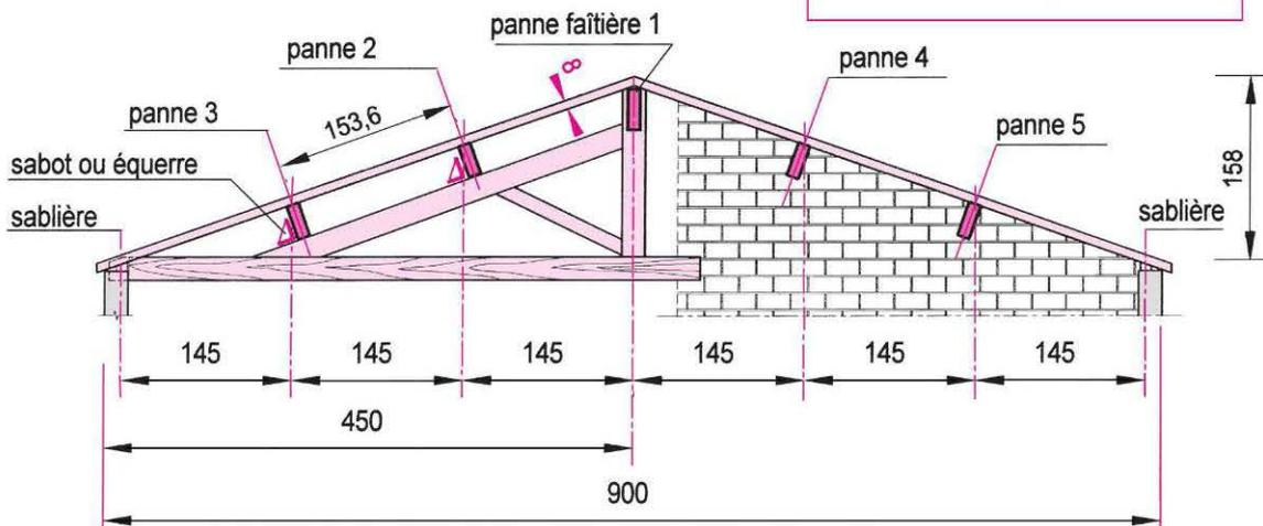
Fig. 64 : Appui des pannes sur la demi-ferme et le demi-pignon maçonné
