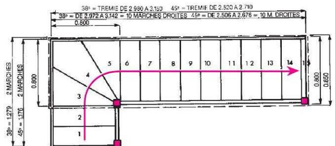
Figure 11 : escalier en L à quartier tournant bas à marches balancées
