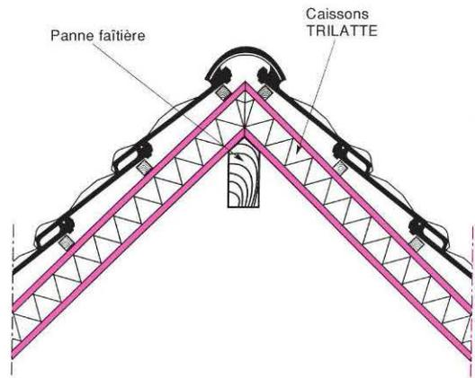
Fig. 37 : Détail de faîtage avec étanchéité par closoir
