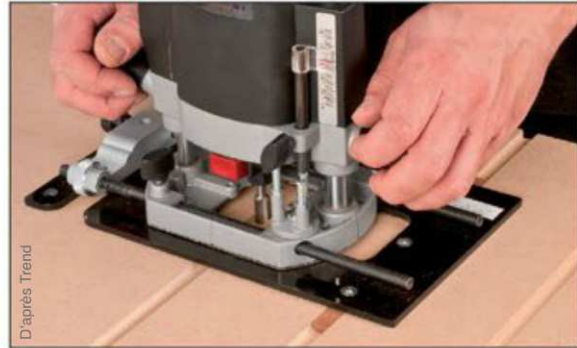
Usinage de rainures parallèles en série
