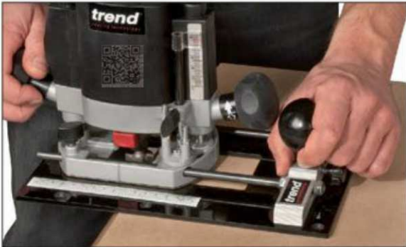
Utilisation en fausse table pour augmenter la surface d'appui
