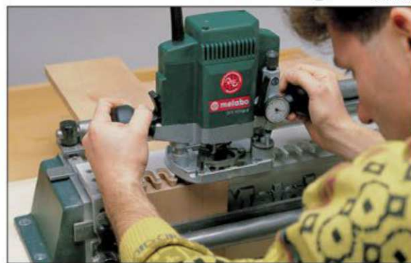
Usinage de queues recouvertes en une seule passe
