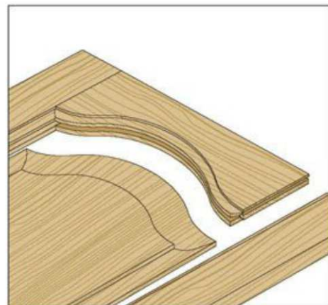
Figure 41 : L'usinage des traverses cintrées (2/2)
