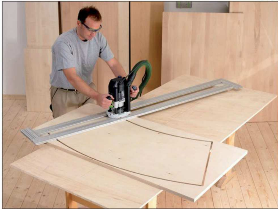
Figure 24 : Système pour découpe de courbes
