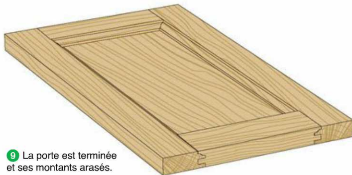
Figure 40 : L'assemblage à profil/contre-profil (2/2)
