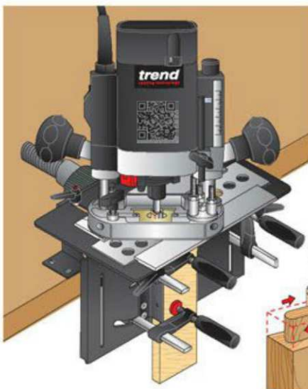
Figure 18 : Exemple de gabarit pour tenons, mortaises et tourillons (1/2)
