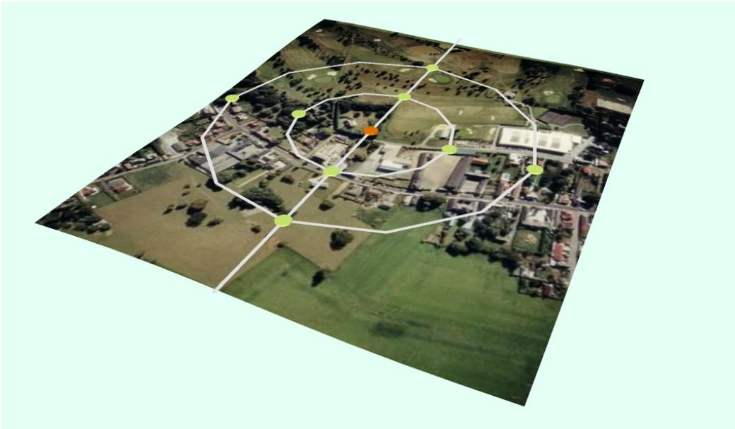
Figure 5-19 : Exemple des points de mesure des altitudes du terrain
