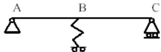
Dans le cadre de ce projet, la rigidité de l'appui central est prise égale à  $k = 2100 kN/m$
